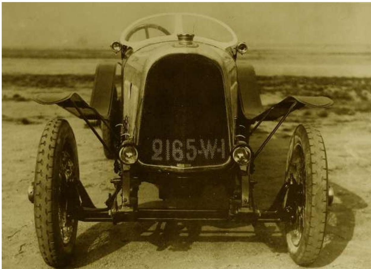
Dessinée par le patron lui-même, elle est construite en quelques jours pour être engagée en courses de côtes, et équipée du 4 litres sans soupape standard, muni de pistons allégés en aluminium et de bielles tubulaires, qui délivre environ 100 cv à 2950 tours minute.
